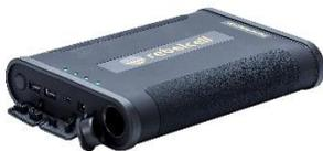
Der Power **Rebel 48K ist eine robuste Powerbank** mit hoher Kapazität (48000 mAh / 153 Wh). Er verfügt über 2 x USB-A-Schnellladebuchsen (QC3.0) und USB-Power Delivery (PD) über USB-C für ultraschnelles Laden. Eine LED-Leuchte und eine 12 V-Ausgang zur Stromversorgung all Ihrer 12 V-Geräte. Damit ist er die ultimative Outdoor-Stromversorgung für Angeln, Camping und Festivals.
